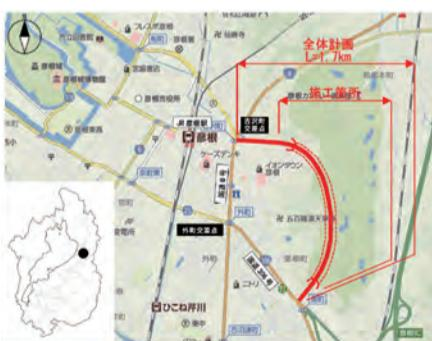
\*彦根市の国道 306 号原町交差点と国道 8 号古澤町交差点を結ぶ 1.7km のバイパス道路建設工事。このうち 1,135m がトンネル工事となっている。国道 306 号と国道 8 号が交差する外町交差点の慢性的な渋滞解消を目的とした事業。
